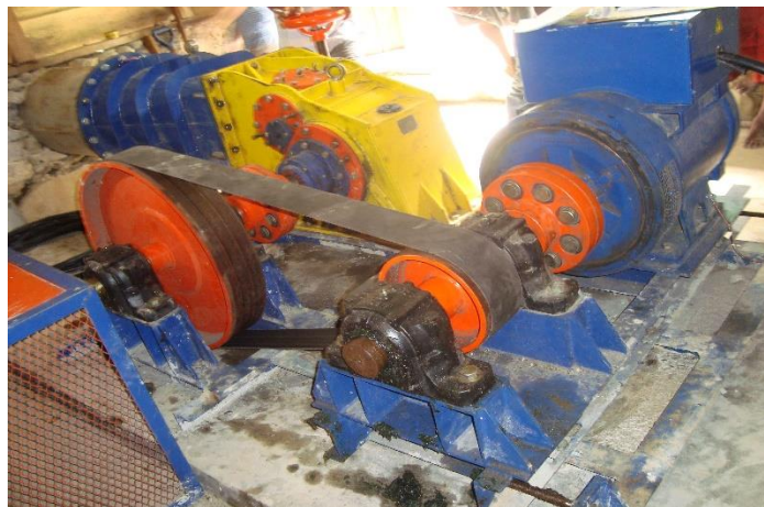
Gambar 2. Turbin Crossflow dan Generator.
