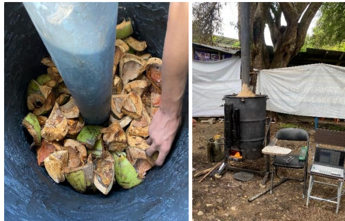
Gambar 3. Proses karbonisasi limbah kelapa muda menggunakan teknologi kiln
