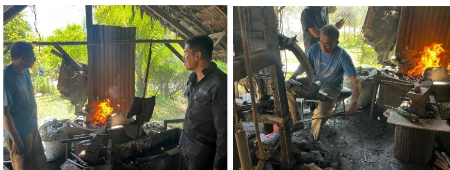
Gambar 5. Proses pemanasan besi dengan menggunakan tungku secara manual dan proses pengempaan besi dengan alat kempa
